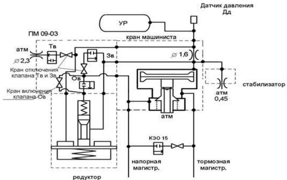
Рисунок 1 – Схема взаимодействия пневмомодуля с краном машиниста
