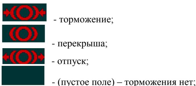
Рисунок 9 – Варианты индикации состояния основного тормоза
