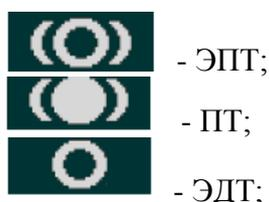
Рисунок 10 – Варианты индикации типа используемого тормоза
