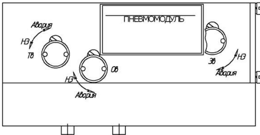
Рисунок 2 – Маркировка редукционных винтов на пневмомодуле
