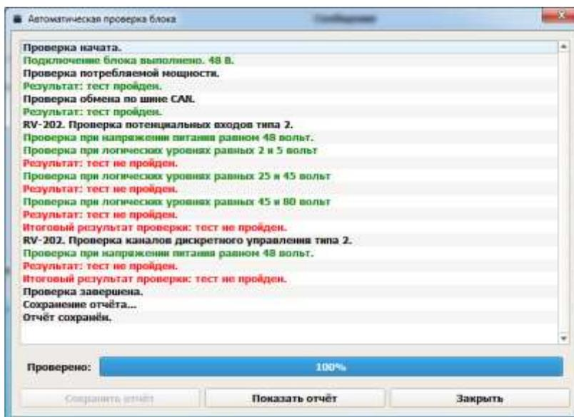
Рисунок В.27 – Окно проверки модуля RV-202-1
