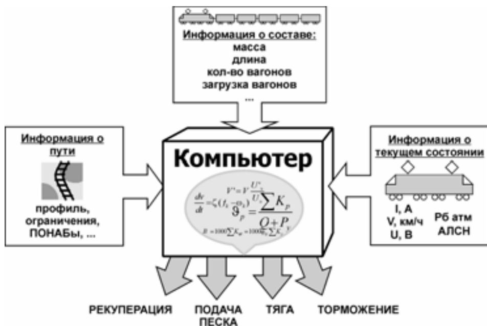
Рисунок 1. Принцип работы системы автоведения
