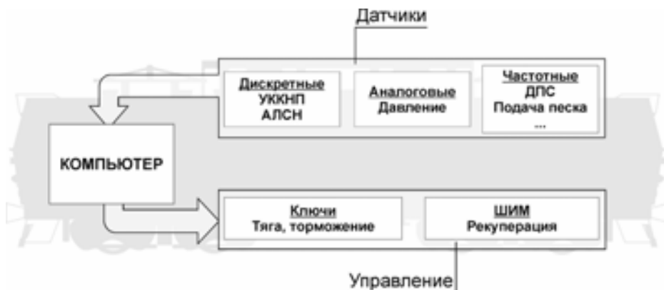
Рисунок 2. Взаимодействие аппаратуры системы автоведения
